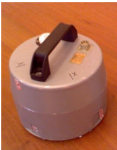
Рис. 2. Трехкомпонентный широкополосный сейсмометр СМЕ-4111-LT
