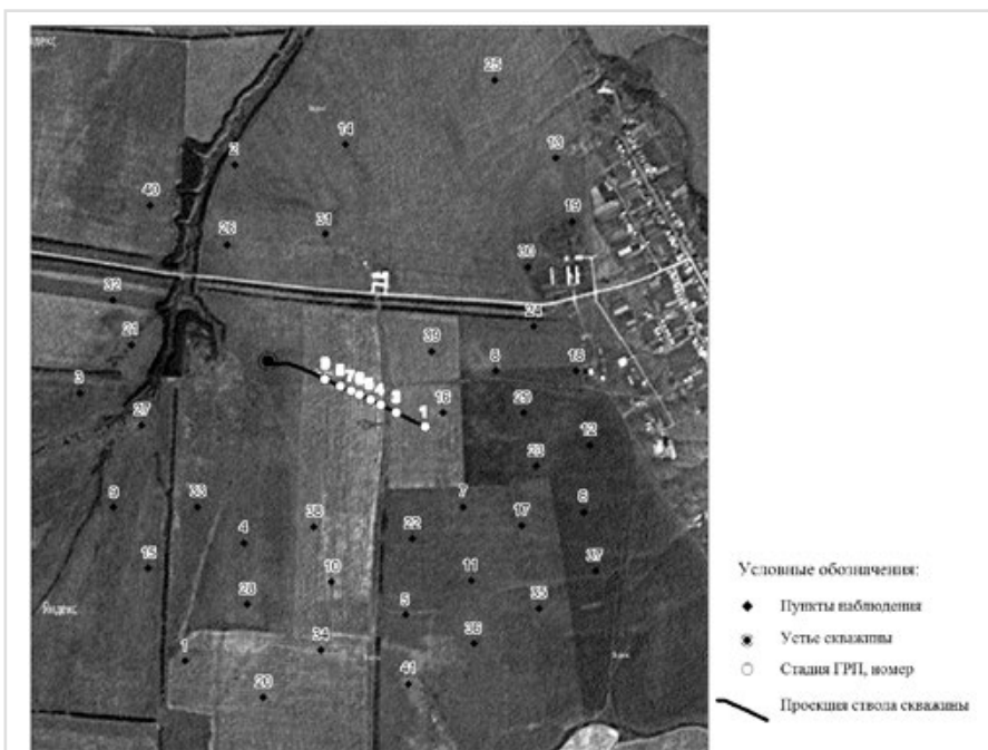
Рис. 2 — Схема расстановки датчиков при мониторинге многоступенчатого ГРП
