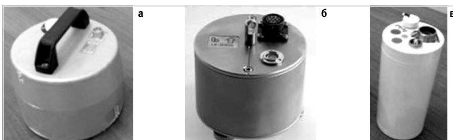
Рис. 3 — Внешний вид сейсмометра «СМЕ-4111-ЛТ» (а), LE-3Dlite (б) и регистратора «Байкал-АСН88» (в)
